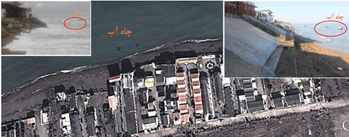
شکل ۲: پیشروی دریا، تغییر خط ساحلی و وجود چاه در داخل دریا ساحل بابلسر، عکس میدانی و Google Earth
