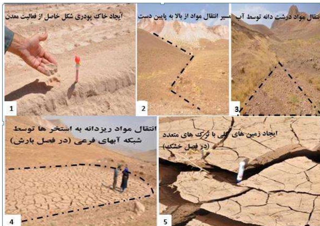
شکل ۴: مراحل انتقال مواد و نخاله ها از طریق آبراهه های فرعی از معدن و دامنه های آن به درون استخرها جهت محاسبه حجم مواد و باطله های حاصل از فعالیت معدن
