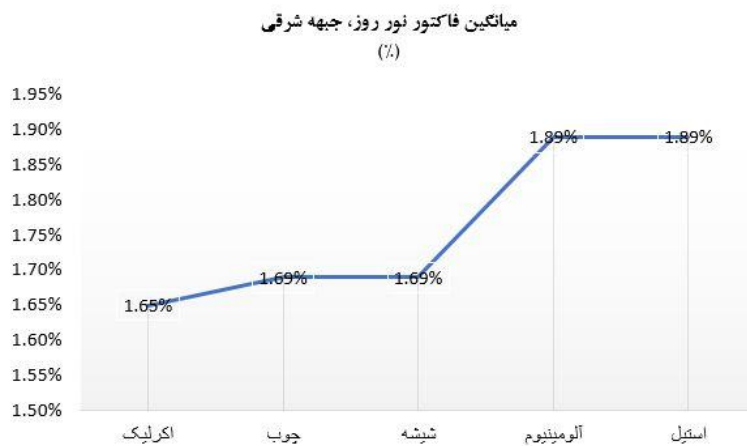
شکل ۶: میانگین فاکتور نور روز در جبهه شرقی با سایه‌انداز از جنس‌های مختلف
