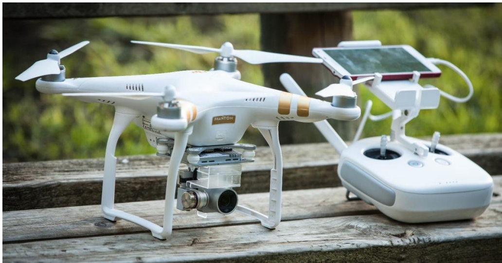
شکل ۲: سمت راست، دسته کنترل (هدایت‌کننده) و سمت چپ، پهپاد Dji Phantom 3 Professional
