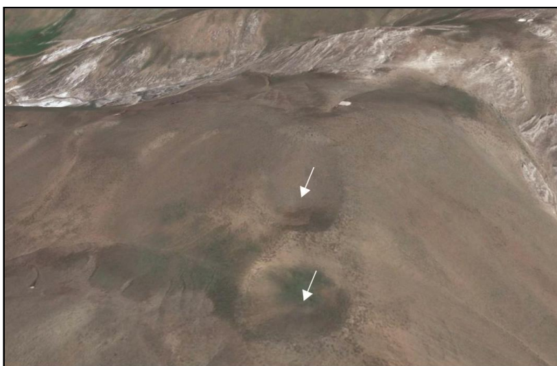
شکل ۴: فرونشست ناشی از کارست در ایستگاه AQRP 1050 در فرودیواره گسل‌های طالقان و کندوان
