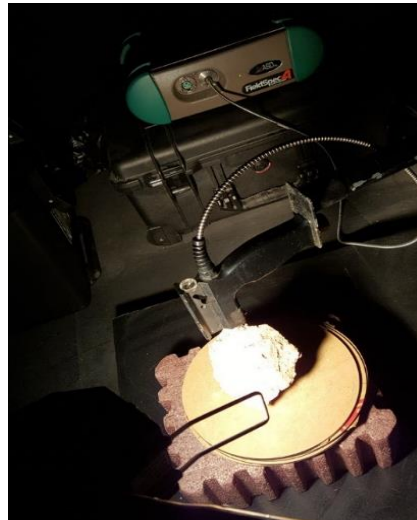
شکل ۳: دستگاه طیف‌سنج مورد استفاده و انجام فرآیند طیف‌سنجی در اتاق تاریک.
