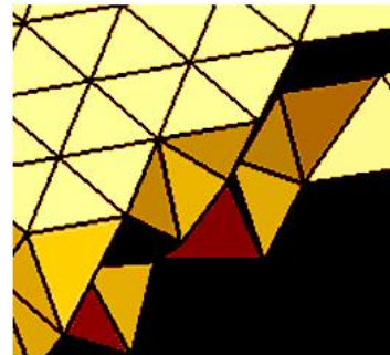
شکل ۵: الگوی درجه آزادی انتقالی بر کار گرفته شده؛ الف: به همراه ساختار چیدمان اجزاء در مجاورت یکدیگر، ب: در مدل مورد مطالعه در این پژوهش. درجه‌های آزادی انتقالی مطابق رابطه ۳ تعریف شده‌اند.
