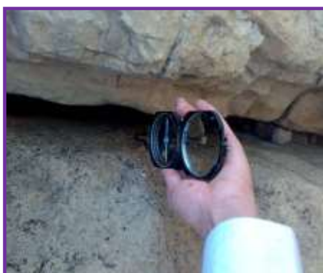
شکل ۱۳: بازشدگی درزه‌ها در آهک ایلام-سروک در تاقدیس پیون
