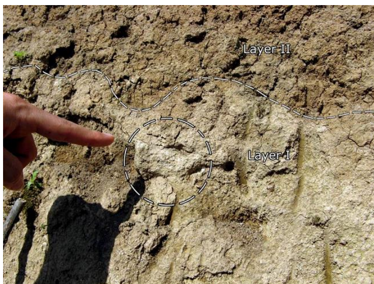
شکل ۱۱: نمایی از یک قطعه آهکی در لایه I در نزدیک مرز بالایی این لایه با لایه II؛ به مرز موج‌دار لایه I با لایه II در این محل توجه شود.
