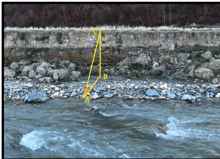
شکل ۳: روش اندازه‌گیری شیب کناره بر روی زمین، A-B فاصله افقی از لبه رود تا کناره، B-C ارتفاع کناره است. زاویه تشکیل شده بین قاعده و وتر مثلث، شیب کناره رود است.
