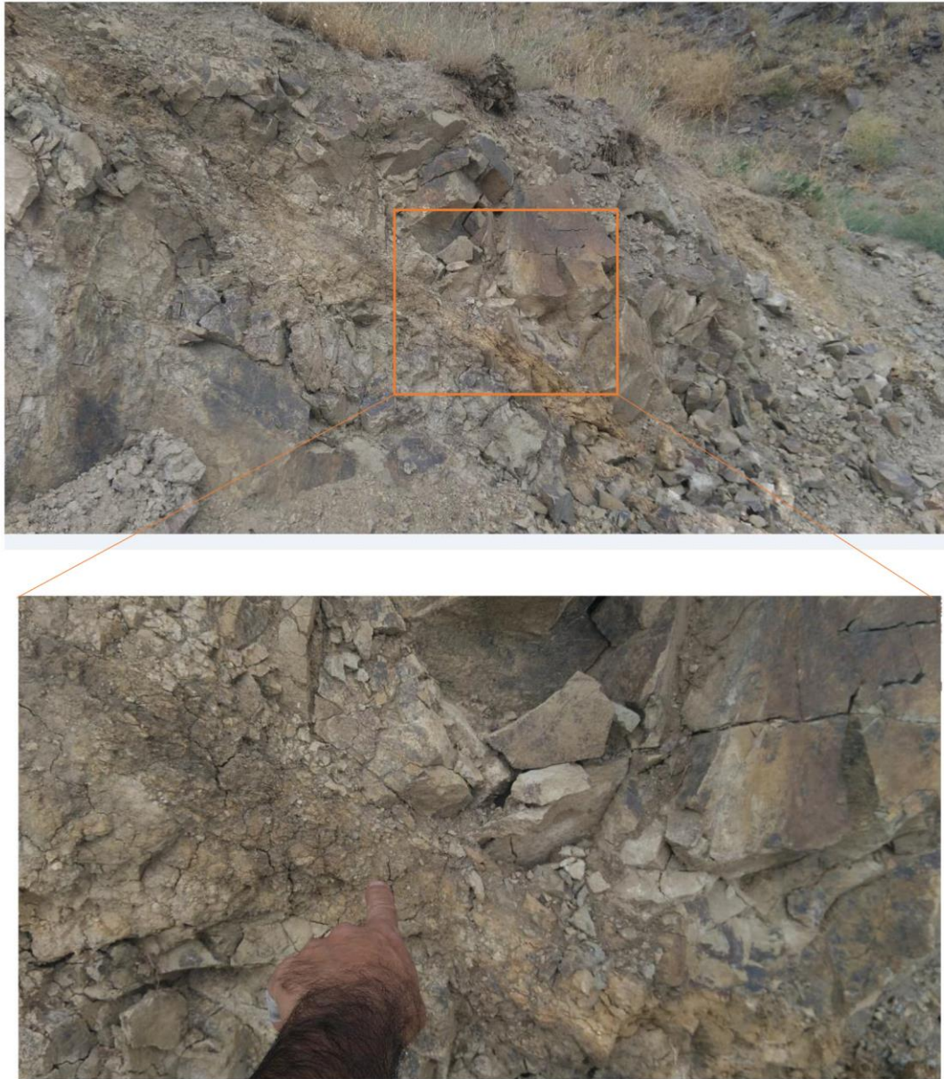
شکل ۲۵: عمده هسته‌های گسل‌های موجود تا حد میلیونیت (رسی) خرد شده‌اند. نمونه‌ای از گسل‌های منطقه در محدوده جنوب معدن، محل دپو S6-7.
