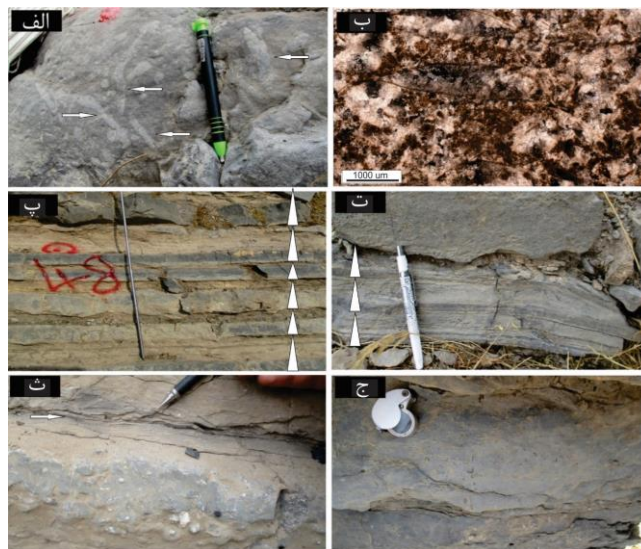
شکل ۶: ریزرخساره E: پکستون-گرینستون حاوی دوکفه‌ای پلاژیک. الف: آشفستگی زیستی و تاثیر جانداران حفار با تغییرات بافتی در نسبت فراوانی خرده‌های دوکفه‌ای پلاژیک در برش کزی، ب: سیمانی شدن شدید پوسته‌های دوکفه‌ای پلاژیک، پ و ت: توالی‌های بوما با سطح قاعده فرسایشی و لامیناسیون موازی تا ریپلی در بخش میانی سازند سرگلو در برش دودان، ث و ج: توالی بوما با دانه‌بندی تدریجی نرمال از خرده‌های دوکفه‌ای پلاژیک، برش دودان.
